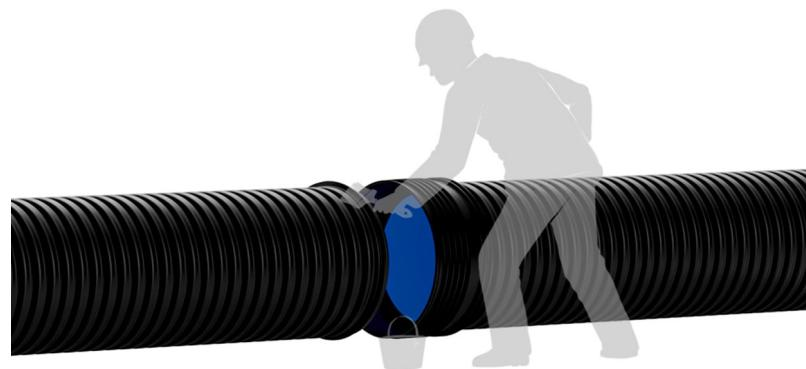
Внутреннюю поверхность раствора и наружную поверхность уплотнительного кольца необходимо покрыть специальной «смазкой-лубрикантом для монтажа полимерных труб». Отметить маркером на конце трубы глубину захода в раствор.
