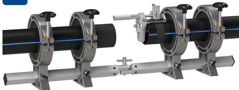
С помощью зачистного инструмента с трубы удаляется поверхностный слой, соприкасающиеся поверхности трубы и соединительной детали (фитинга) обрабатываются при помощи специальных салфеток для обезжиривания полимерных труб.
