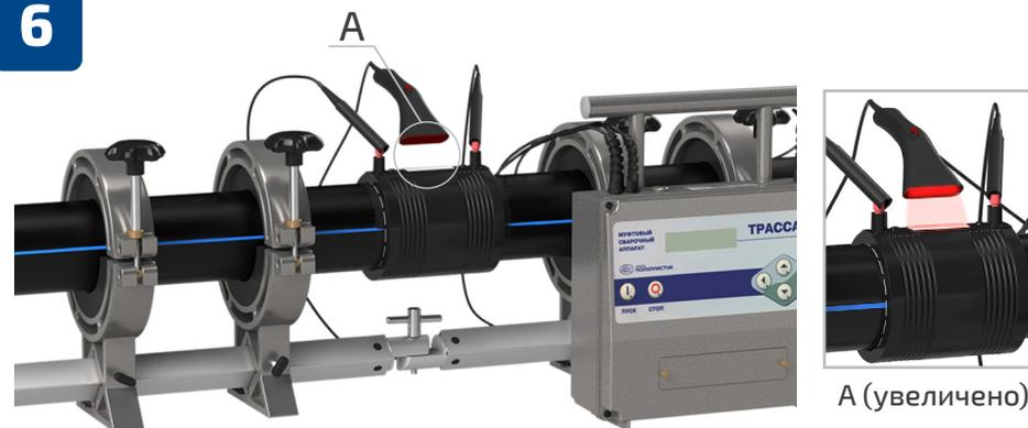
Параметры сварки вводятся в аппарат с помощью сканера штрих-кодов
